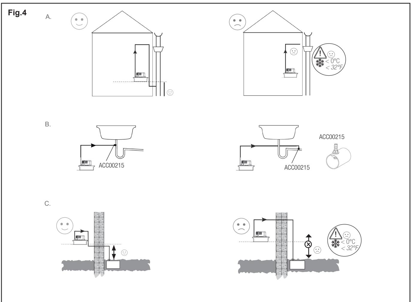
Les pompes de relevage de condensats SI 1805 et SI 1820 sont destinées à relever des condensats chargés. Elles sont particulièrement adaptées aux armoires frigorifiques, consoles, évaporateurs, vitrines réfrigérées, chaudières à gaz dont les condensats n'ont pas un PH inférieur à 3,4. Ce sont des pompes centrifuges monobloc.
